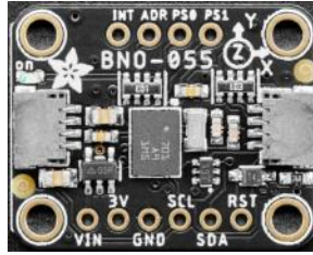
Figure 107: Adafruit BNO055 IMU
